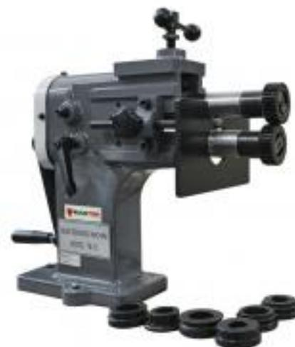
Стабильная конструкция с валом разгоняемым с помощью рукоятки служит для зиговки, отбортовки кромок, а также их формовки нижний вал с регулируемым ограничителем высокая точность исполнения благодаря чётко установленным валом
